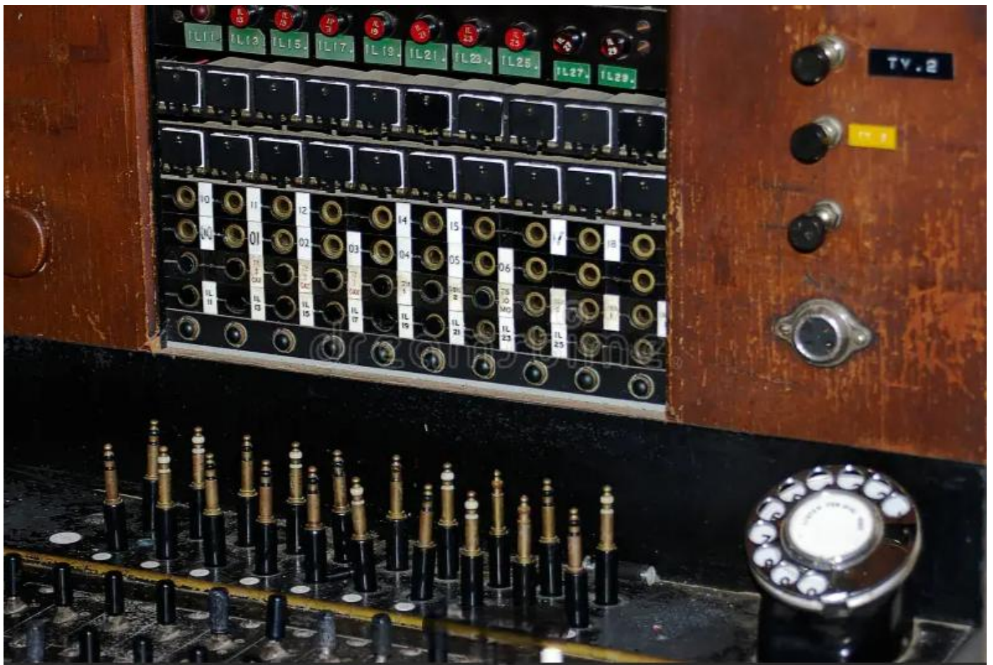
Met behulp van deze stekkers werd er verbinding gemaakt.
